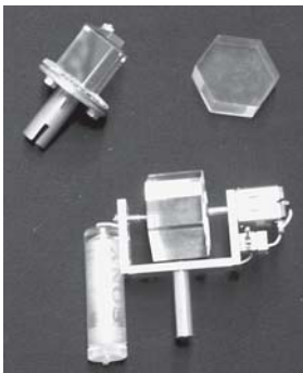
Abb. 9: Glasprisma in Drehhalterung, hexagonaler Plexiglaskörper sowie eine Hal- terung mit hexagonalem Plexiglaskörper für zweiachsige Rotation (links). Die Proben können mit einem Motor oder Akkuschauber in Rotation versetzt werden (rechts) und dienen der experimentellen Darstellung von Haloerschein- ungen (Foto: M. Vollmer).
