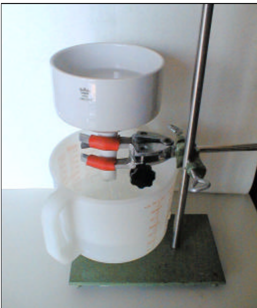
Filtrieren von radonhaltigem Wasser
